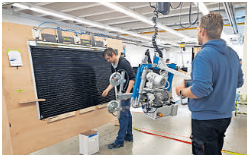
Bau von Solarpanels
